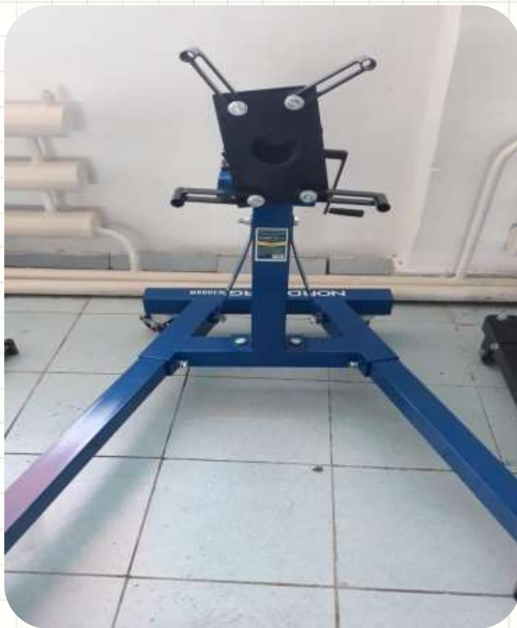
ДВС, БӨП, салмағы 0,8 т дейінгі артқы көпірлерді бөлшектеуге-құрастыруға арналған р500е стенді, жетегі- механикалық
